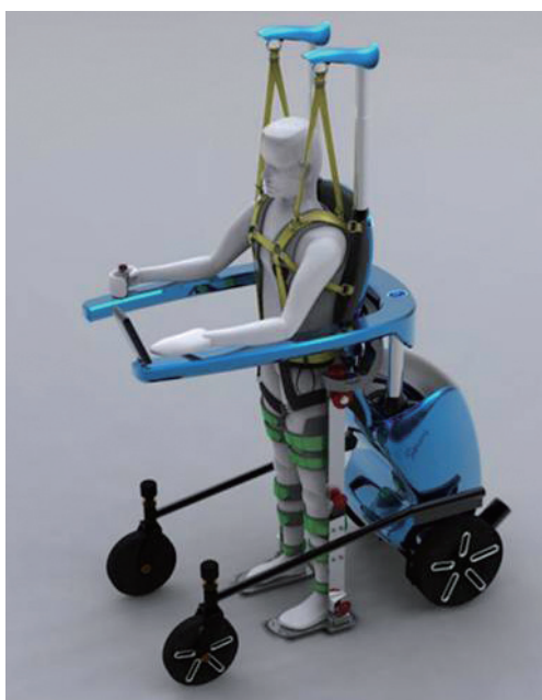
Fig. 2 휠체어 결합형 하지 운동/재활훈련 시스템
