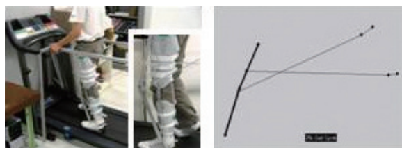
Fig. 6 링크시스템 기반의 하지 재활장치
