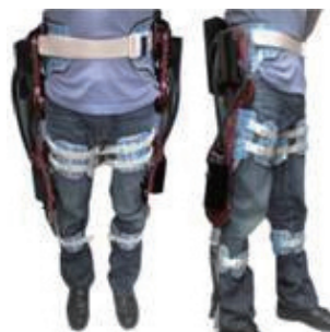
Fig. 4 역구동성이 보장되는 하지 보행보조로봇
